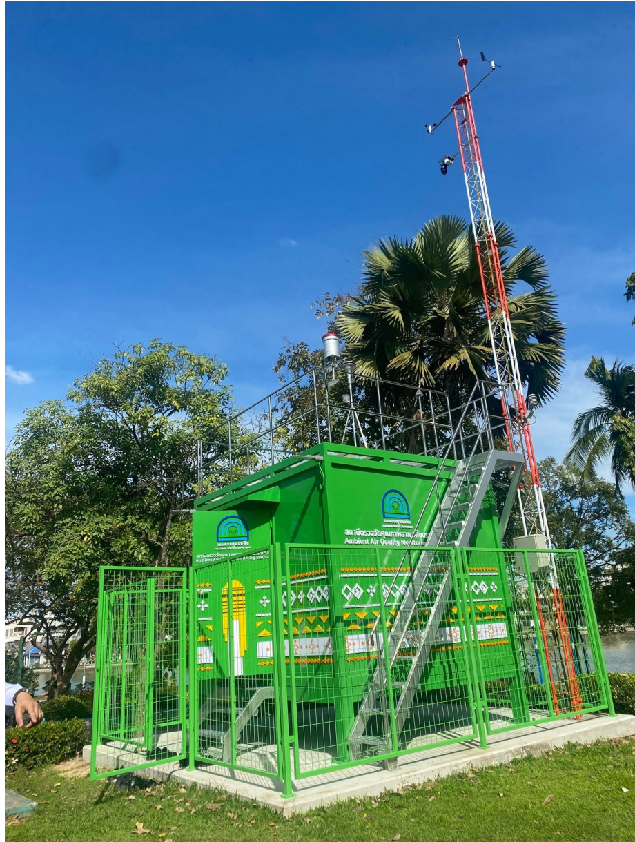
รูปที่ 7-30 สถานีตรวจวัดคุณภาพอากาศในบรรยากาศ ณ จังหวัดร้อยเอ็ด ของกรมควบคุมมลพิษ ที่มา : กรมควบคุมมลพิษ กระทรวงทรัพยากรธรรมชาติและสิ่งแวดล้อม
