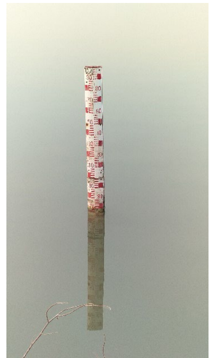
รูปที่ 7-37 ระบบตรวจวัดปริมาณน้ำเก็บกักในแหล่งน้ำขนาดเล็กของกรมทรัพยากรน้ำ
